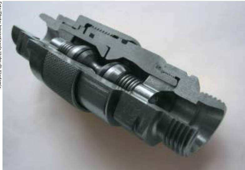
Abb. 3: Schnittbild – Schraubkupplung nicht 100 % verschraubt.
