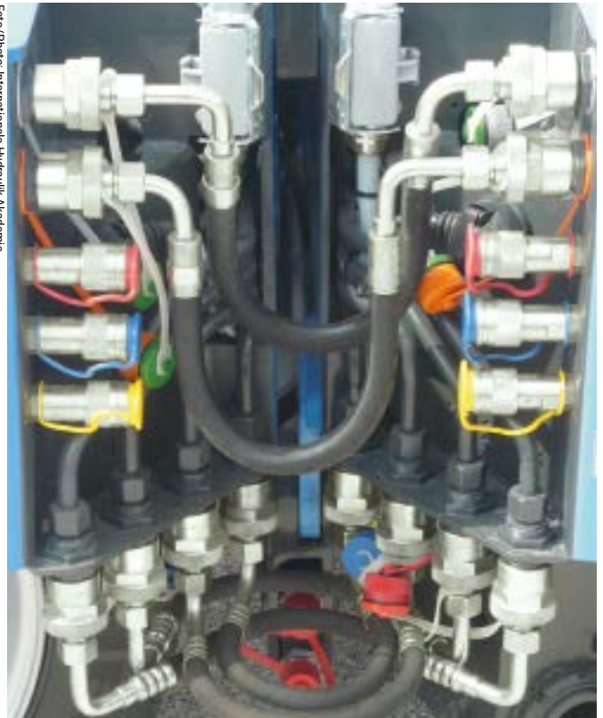
Abb. 1: Praxisbeispiel Einsatz von Schraubkupplungen
