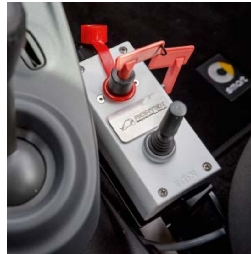
Mittels eines Joysticks kann der Fahrer den einscharigen Schneepflug bequem vom Cockpit aus stufenlos steuern.
