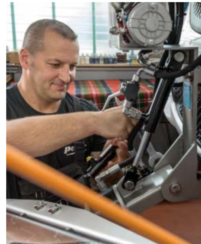
Die von HANSA-FLEX verbauten Hydraulikbauteile wie Schlauchleitungen, Zylinder und Verschraubungen sind für die extreme Beanspruchung ausgelegt.
